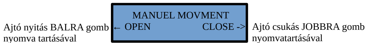
Ábra-12: Kézi vezérlés képernyő
