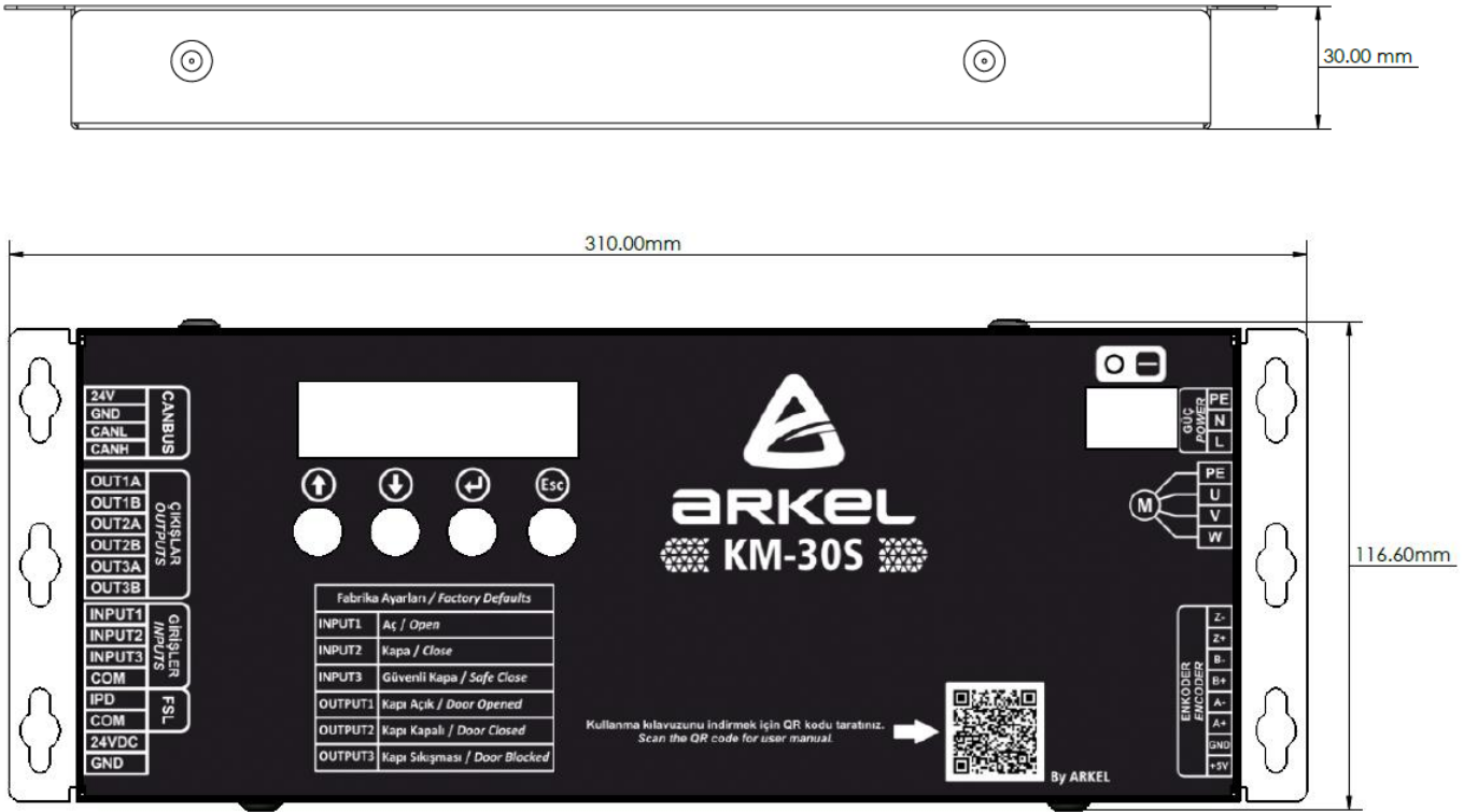
Şekil 13 KM-30S Uzunluk x Genişlik x Yükseklik Ölçüleri
